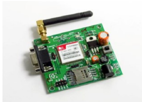
Fig-4: GSM modem using SIM900 module
