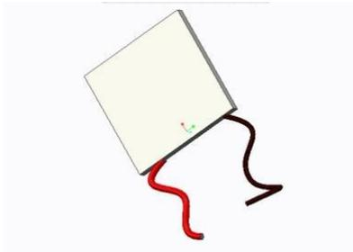
FIG.3. Peltier Module
