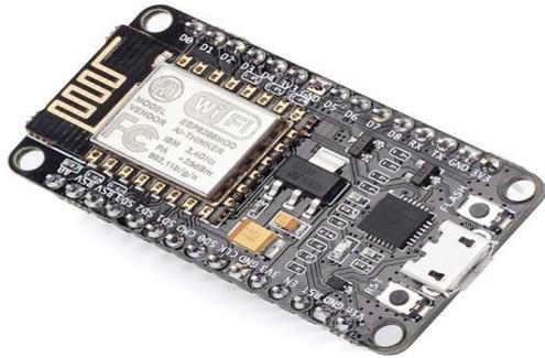
Figure 6 : ESP8266mod (NodeMCU).
