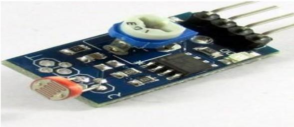
Figure 10 : LDR Light sensor module.
