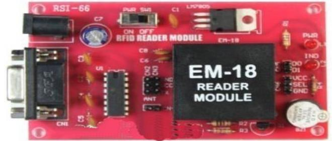
Figure 8 : RFID reader circuit.
