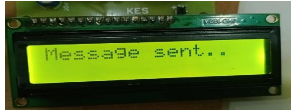
Fig 5. GSM module sent message
