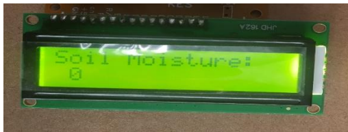
Fig 1. Moisture value displayed on LCD
