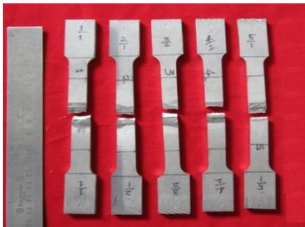
**After tensile test**
