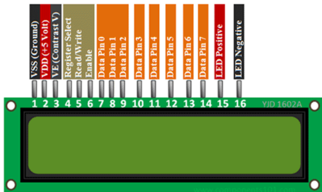
Fig.3 16x2 LCD Module
