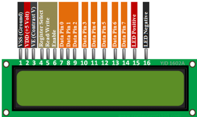
Fig.3 16x2 LCD Module
